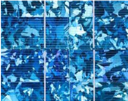
Photovoltaikzellen bestehen aus einem Halbleitermaterial, meist Silizium.
